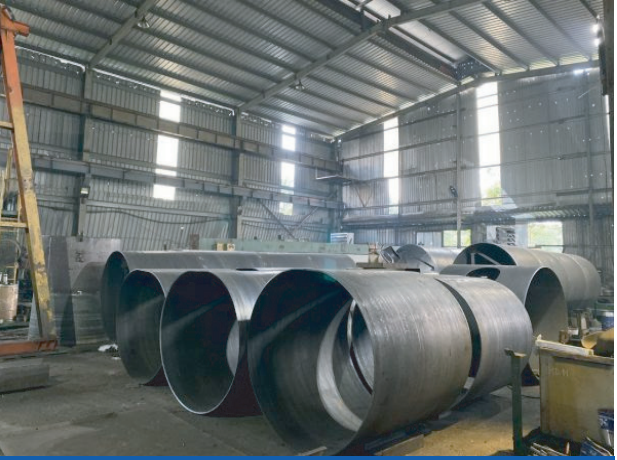
■ Ống cọc nhồi D1200
